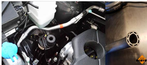
Foto 5. Intercambiador de calor interno para refrigerante R1234yf (foto: NRF)
