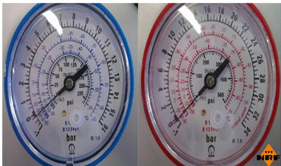
Foto 3 y 4. Manómetro de baja y alta presión para R134a y R1234yf.
