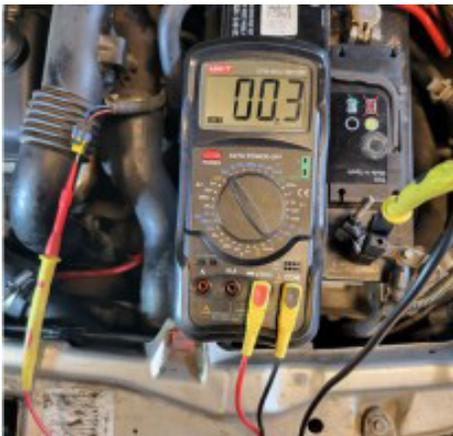
En caso de no conexión, hay que controlar la continuidad del hilo rojo-blanco entre los puntos: pin n°. 45 (del conector B de la ECU) y el pin A del enchufe del sensor. La unidad de control del motor se encuentra encima de la tapa de válvulas en la parte trasera. Siguiendo las marcas en el zócalo de la ECU, ubica el pin 45. Si el cable está roto, ubica el daño y repara el arnés de cableado de acuerdo con la tecnología del fabricante.
