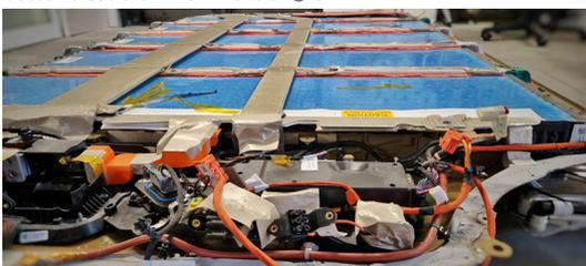
La limite supérieure de la température de fonctionnement de la batterie se situe généralement autour de 40°C à 45°C.
