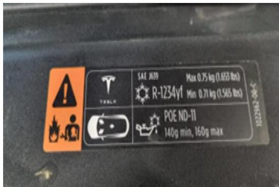
Imagen 5. Información sobre refrigerante y aceite en la placa de características bajo el capó NRF Tesla Model S
