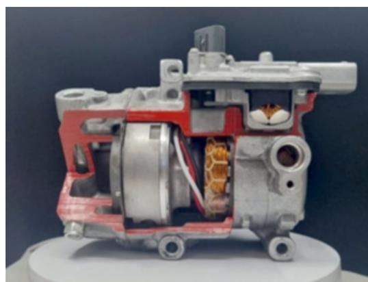
IMAGEN 1. COMPRESOR ELÉCTRICO CORTADO NRF
