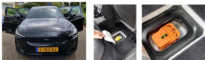
Imagen 4. Enchufe de seguridad para desconectar el Geely Polestar2
