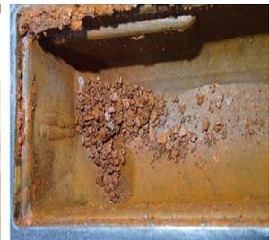
Foto 4 y 5. Muestra de agua del grifo utilizada como refrigerante y corrosión del motor. (Foto NRF)
