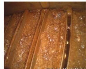
Foto 2. y 3. Sedimentos de óxido dentro de los tubos del radiador.
